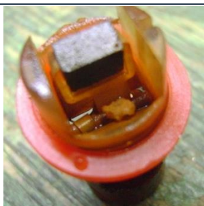
Figura B – Fluxostato travado por pedra de cálcio.
