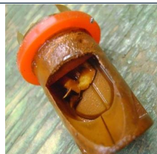
Figura C – Fluxostato travado por sujeira.
